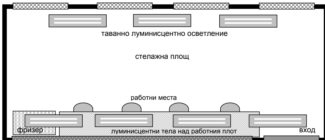
Фиг. 5. Интериорна скица на зала III след ремонта
